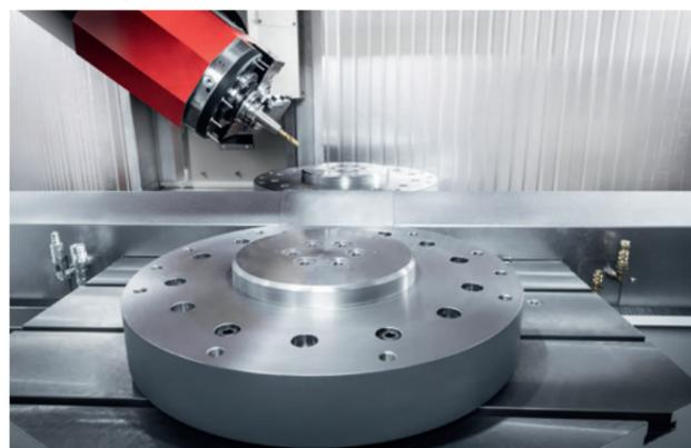
Abbildung der beiden Arbeitsräume mit geöffneter Sicherheitstrennwand.
