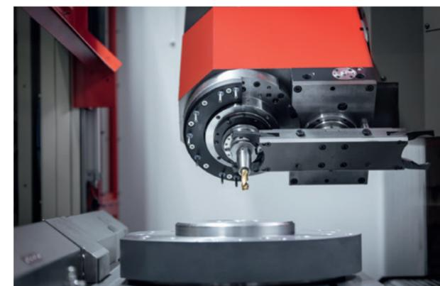
Stufenloser Schwenkkopf für Mehrseiten- oder Endenbearbeitung.
