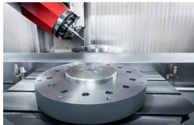
Abbildung der beiden Arbeitsräume mit geöffneter Sicherheitstrennwand.
