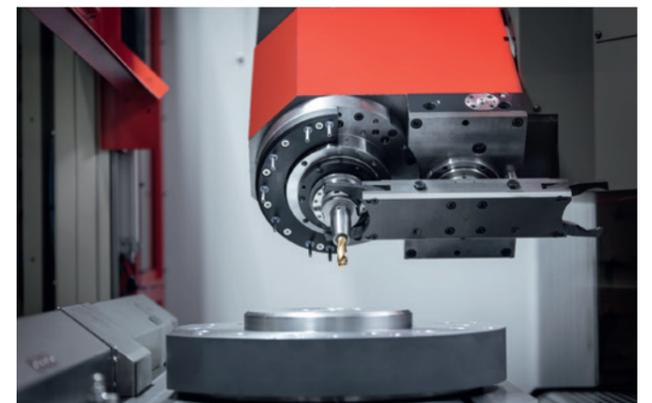
Stufenloser Schwenkkopf für Mehrseiten- oder Endenbearbeitung.
