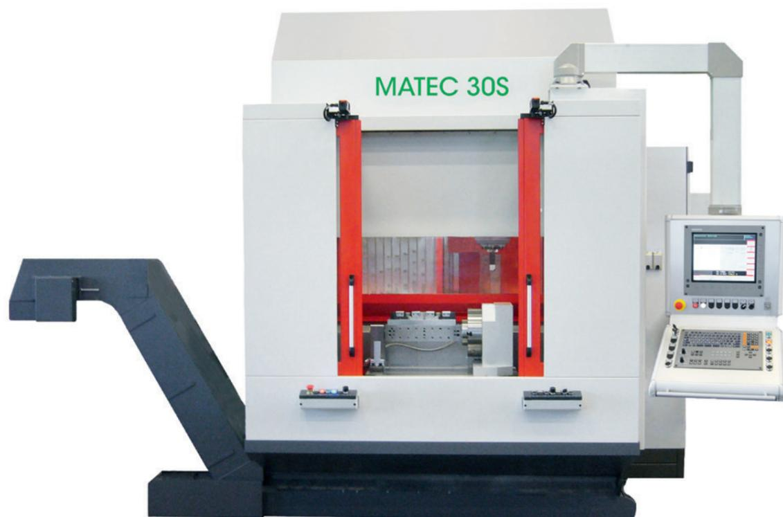
Das Fertigungsprinzip der MATEC 30S beruht auf einem 0-180° Pendelschwenktisch mit zwei Arbeitsräumen. Der Arbeitsraumwechsel erfolgt durch eine 180°-Drehung des Schwenktisches.
