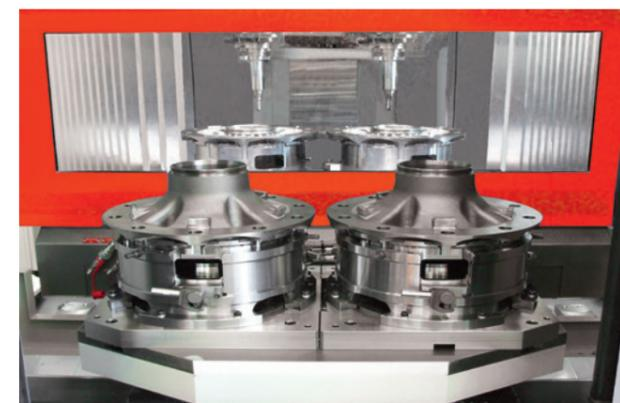
Arbeitsraum 1: Ladestation. Hydraulisch betätigte Doppelspannvorrichtung für Automation.
