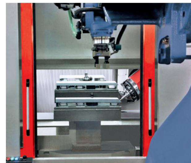
Ansicht der Arbeitsräume mit geöffneter Sicherheitstrennwand in der Schwenktischmitte. 6-Achs-Roboter in Entnahmestellung.
