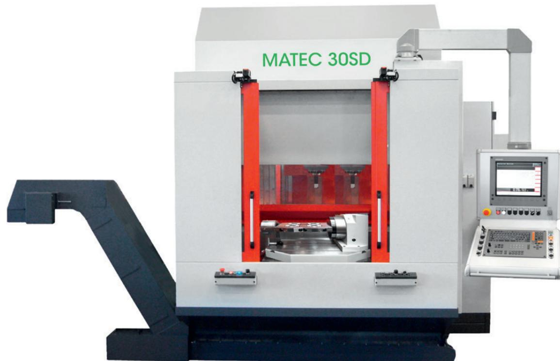
Das Fertigungsprinzip der MATEC 30SD beruht auf einem 0-180° Pendelschwenktisch mit zwei Arbeitsräumen. Der Arbeitsraumwechsel erfolgt durch eine 180°-Drehung des Schwenktisches.
