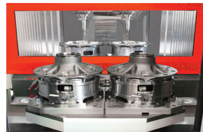
Prac. časť 1: Nakladacia stanica. Hydraulicky ovládané zariadenie na dvojité upnutie pre automatizáciu.
