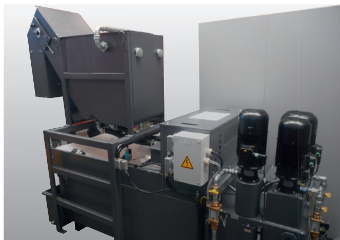
Kühlmittelanlagen mit Kantenspalfilter
