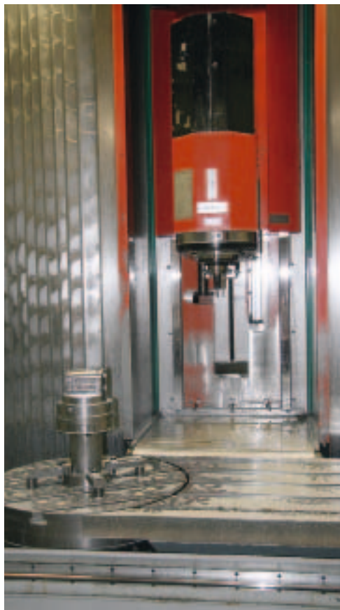
Die 30 HV mit 630er-Rundtisch wird vorwiegend zur Herstellung von Stanzwerkzeugen genutzt, steht aber auch für andere Aufgaben zur Verfügung.
