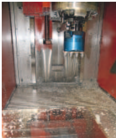
Mit dem 8-fach-Mehrspindelbohrkopf werden 6.500 Bohrungen mit dem Durchmesser 1,2 mm auf einer Länge von 3,2 m gebohrt.
