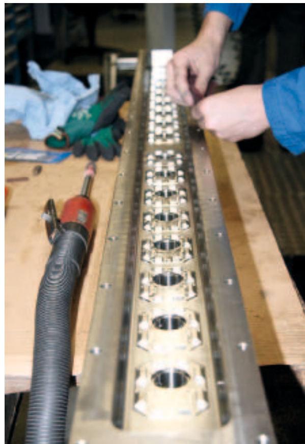
Traverse dient als Trägerelement für einen Optikkopfadapter der in der Druckindustrie Belichtungsplatten für den Siebdruck hält.
