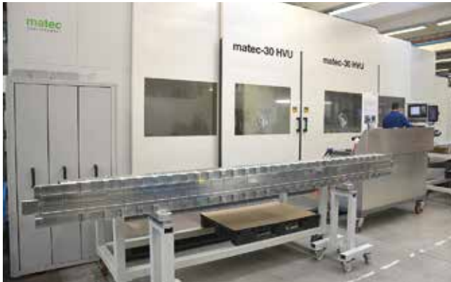
6 Das zweite 5-Achs-Fahrständer-BAZ aus dem Hause Matec bei Durst in Brixen, eine matec-30 HVU; im Vordergrund ein montierter Träger mittlerer Größe für den Druckschlitten (Bild: Hanser)
