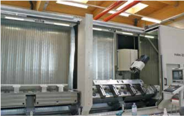
3 5-Achs-Fahrständer-BAZ matec-30 HV mit Schwenkbrücken-Technologie: In Lienz nutzt man regelmäßig die nebenzeitarme Pendelbearbeitung mit aufgebauter Trennwand (Bild: Stiebinger)
