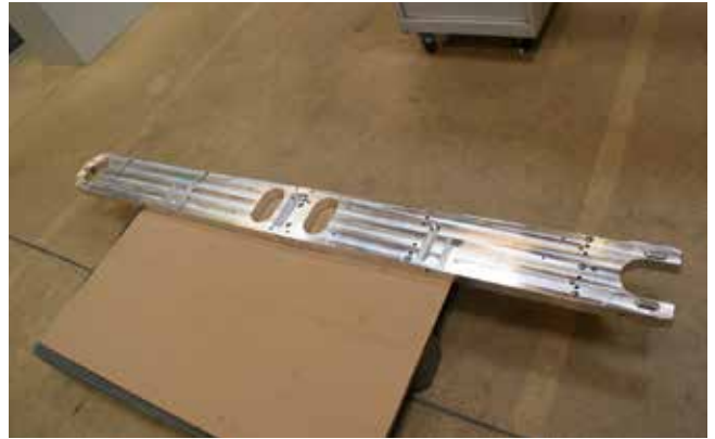
4 Wellenhalter für den Bandaufbau des Medientransports: Zahlreiche Funktionsmaße prägen das Bauteil, das auf der matec-30 HV an sechs Seiten bearbeitet wird (Bild: Stiebinger)
