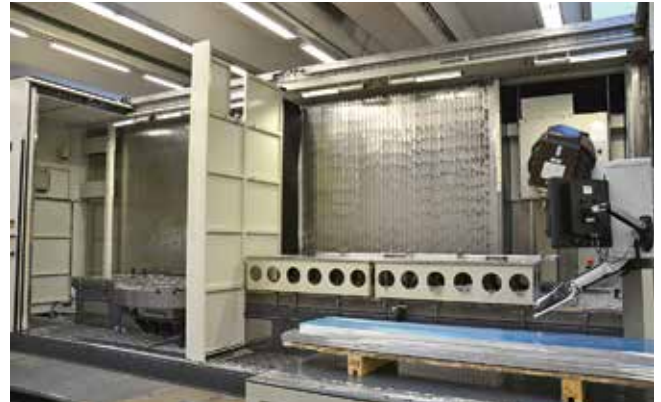
7 Blick in die 7-m-Maschine in Brixen: die matec-30 HVU mit geteiltem Arbeitsraum, NC-Rundtisch (links) und 2-Achs-Universal-Schwenkkopf (rechts) (Bild: Hanser)
