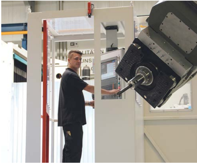
Das Bedienpult ist am Portal angebaut, so dass der Bediener immer am ‚Ort des Geschehens‘ ist.
