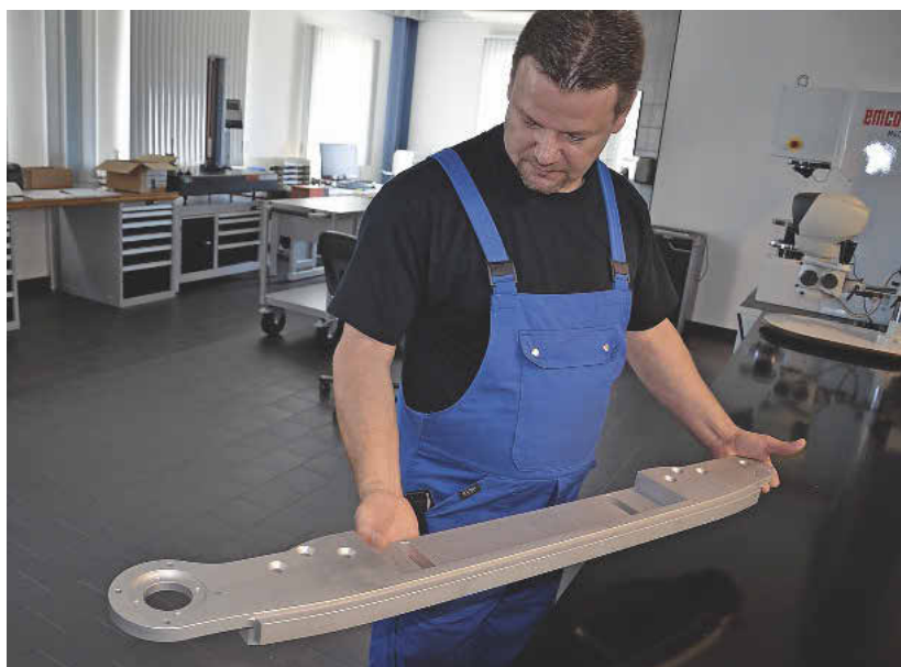
Teil einer Kettenführung für einen Getränkeabfüllanlagenhersteller. Auch dieses Teil wird auf der HV aus dem Vollen gefräst.
