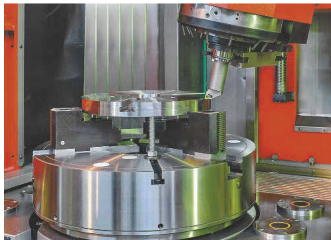
Der Torque-Rundtisch in den 30 HV Maschinen erlaubt mit seinen 800 U/min in Kombination mit der Schwenkspindel auch anspruchsvolle Drehoperationen. Bild: Köppl
