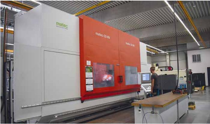
Die Matec 30HV mit Verfahrwegen 4.000 x 1.000 x 1.000 (X, Y, Z) mm ist für die Bearbeitung größerer Werkstücke ausgelegt.
