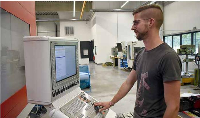
Alle Fräsmaschinen bei Kulina sind mit Heidenhain-Steuerungen ausgerüstet, wobei an die Matec 30HV eine iTNC 640 adaptiert ist.
