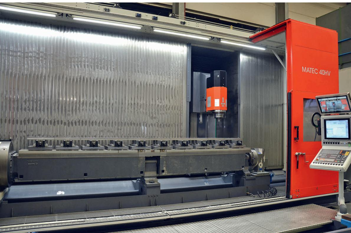
1 Das 5-Achs-Fahrständer-Bearbeitungszentrum Matec 40HV in der Eigenfertigung von Schechtl: Die Schwenkbrückenmaschine mit HV-Schwenkkopf beseitigte 2022 einen Kapazitätsengpass in der Langteilmfertigung und sorgt seitdem für eine höhere Produktivität © Hanser
