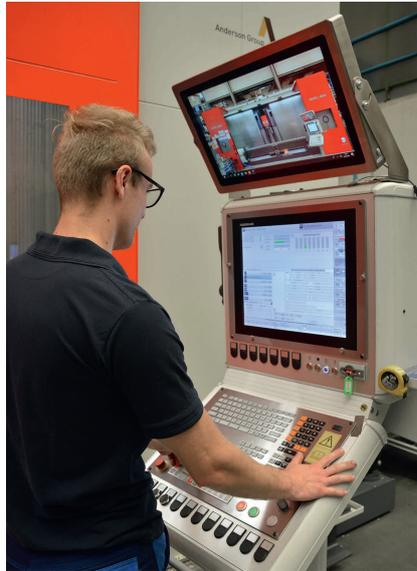
**5** Prädikat empfehlenswert: Die beiden als Option gewählten Innenraum-Farbkameras liefern dem Maschinenpersonal auf einem gesonderten Monitor oberhalb des TNC-640-Bedienfeldes einen permanenten Einblick in die Prozessabläufe und ermöglichen zudem gezielte Dokumentationen, etwa von Aufspannsituationen, die im Wiederholfall an der Steuerung einsehbar sind © Hanser
