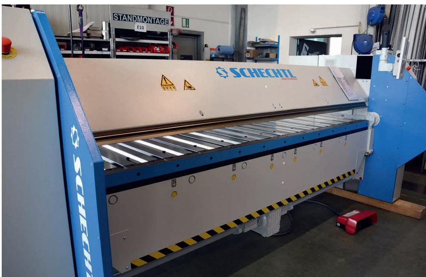
2 Schwenkbiegemaschine von Schechtl: Zu erkennen ist die obere Führungsschiene, die in kundenspezifischen Versionen und mit Längen bis 4200 mm in maximal zwei Aufspannungen auf der Matec 40HV gefertigt werden © Hanser
